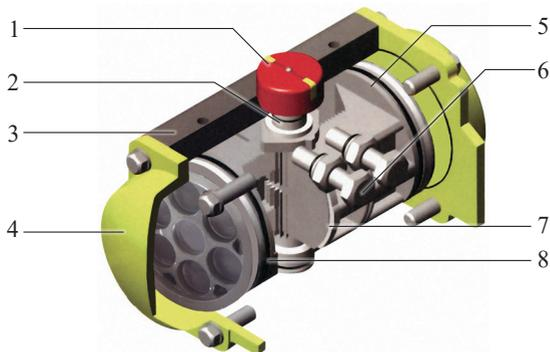
1. Индикатор положения (стандарт NAMUR): предназначен для установки ПЭР-1000Р, РПДП, БИП.
