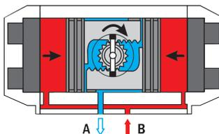
Сжатый воздух, поступающий в порт В, возвращает поршни в исходное положение, закрывая кран (исполнительный механизм), при этом зубчатый вал вращается по часовой стрелке. Воздух выходит через порт А.
